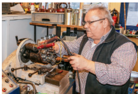
Leistungstest: Auf dem Prüfstand muss der Anlasser unter Realbedingungen zeigen, was er kann. Vorher war es weniger als ein PS
