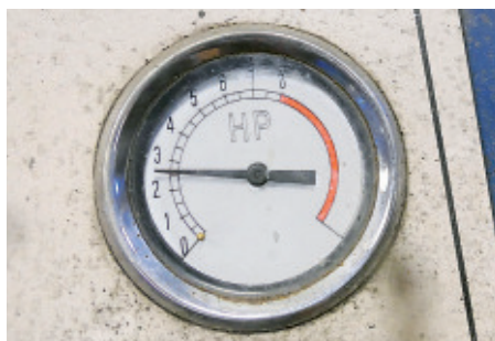
Nun zeigt das Meßgerät stolze 2,5 bis 2,8 PS an. Genug, um auch einen müden Bulldog für die nächsten Jahre in Schwung zu bringen
