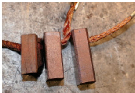
Kohlenvergleich: Links falsch und verschlissen, in der Mitte falsch und neu. Rechts die passende lange Kohle mit geflochtener Leitung
