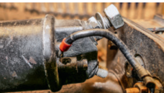
Gegen das Aufdröseln hilft ein Verschrauben mit einer Aderendhülse. Alternativ kann man das Kabelende natürlich auch verlöten
