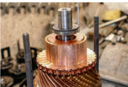
Ausgleich: Auch auf der Kollektorseite legt der Experte eine Reibscheibe bei. Das dient zudem der Einstellung des Axialspiels
