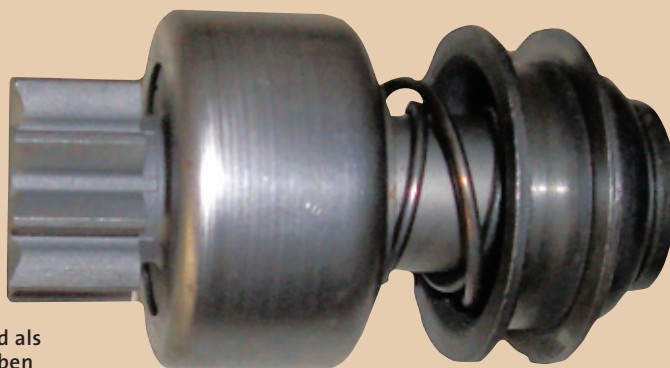
Beim Starten erhält der Magnetschalter Strom und zieht die Gabel an. Die beiden Bolzen schieben das Ritzel auf der Keilwelle in die Schwungradverzahnung
