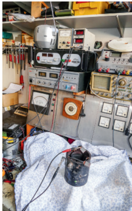
Feldtest: Auf dem Prüfstand erfolgt der Check der Feldwicklungen. Nur Messen unter hoher elektrischer Belastung gibt richtige Werte
