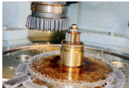
Zahn-Technik: Ersatz für defekte Ritzel fertigt Wilhelm Jahn auf der Stoßmaschine an. Außen- und Innenverzahnungen entstehen in der ...
