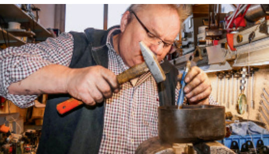
Vorsicht Falle: Vor dem Aufsetzen beult Jahn den Deckel aus. Sonst kann es feurigen Kontakt mit den „heißen“ Brückenkontakten geben
