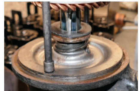
Feder-Druckscheibe-Reibscheibe – nur in der korrekten Reihenfolge zusammengebaut kann die Bremse dem Anker den Schwung nehmen
