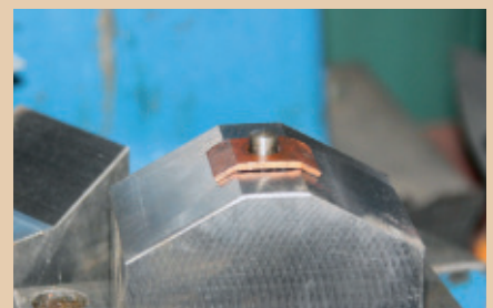
Das Kontaktblech überträgt beim Anziehen des Schalters den Strom von der Batterie auf die Brückenkontakte und ist elektrisch hoch belastet
