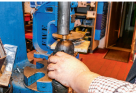
Ein einfache Spindelpresse genügt, um das neue Ritzel an seinen Platz zu bringen. Nach dem Pressen den Freilauf der Welle prüfen
