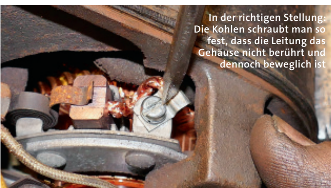
Gegen das Aufdröseln hilft ein Verschrauben mit einer Aderendhülse. Alternativ kann man das Kabelende natürlich auch verlöten
