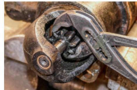
... eigenen Werkstatt. Spielprobe: Ein kurzer Dreh am Anlasserritzel und etwas Hin- und Herwackeln offenbaren Spiel auf der Welle
