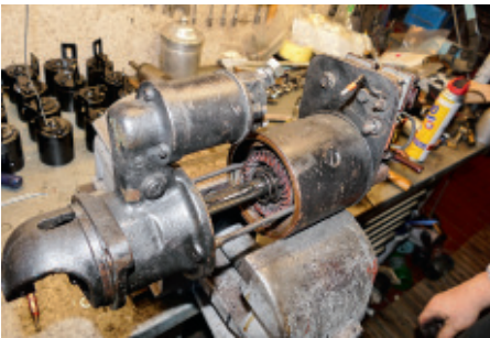
Ist der Anfang gemacht, lässt sich der Starter leicht auseinander ziehen. Die weiteren Arbeiten sind fast wie bei anderen Anlassern
