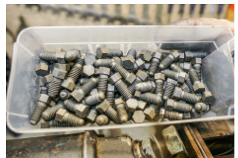
Für den Anschluss der Steuerleitung wird das Kabel mit einer M6-Schraube mit balligem Ende und 7-mm-Schlüsselweite verschraubt
