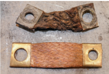
Alt gegen neu: Etliche zerstörte Einzeldrähte verhindern beim Altteil den ungehinderten Stromfluss. Das Neuteil ist perfekt gewebt
