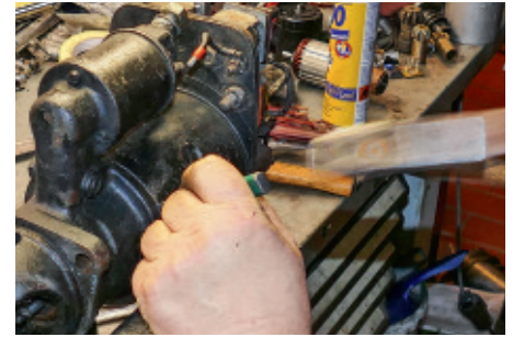
Nachhilfe: Um den Anlasser nach dem Entfernen der Muttern zu trennen, hilft der Experte mit feinen Schlägen nach
