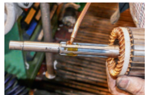
Gut geschmiert: Öl sorgt für leichtes Gleiten der Keilverzahnung zwischen Ritzel und Ankerwelle und ermöglicht so schnelles Ausrücken
