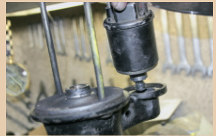
... des Achsbolzens ist die Ausrückgabel im Gehäuse bereits lose, der Magnetschalter (rechts) lässt sich nun einfach aushängen
