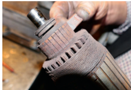
Abgekokelt: Ausgebaut zeigt der Anker seine Brandwunden am Kollektor noch deutlicher. Stellt sich die Frage „Überholen oder erneuern?“
