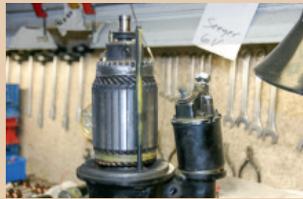
Ist die Demontage so weit gediehen, braucht man vor dem Magnetschalter auch nicht mehr haltmachen. Mit dem Entfernen ...
