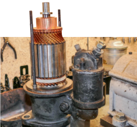
Ein moderner Anker soll für gute Startleistung sorgen. Er wird einfach in die Verzahnung gesteckt. Dabei auf richtigen Sitz der Scheiben achten
