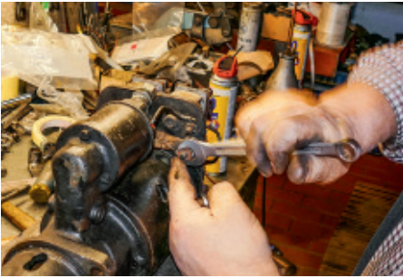
Wird gern vergessen: Vor dem weiteren Zerlegen unbedingt das Stromband zwischen Magnetschalter und Anlasser abschrauben
