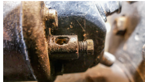
Ohne Kabel oder Schlüssel im Weg ist gut zu erkennen, dass der Schraubenkopf nicht über seinen Sitz herausragt
